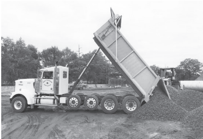
Ejemplos de equipos de construcción pesados que pueden requerir una cobertura mínima adicional. Contech puede ayudar a evaluar la cobertura mínima para el contratista de instalación para todos los equipos en el sitio.
