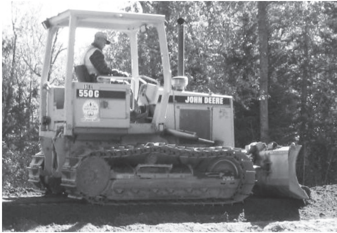
Ejemplos de equipos de construcción ligeros y con orugas utilizados para colocar la cubierta final sobre el sistema de tuberías.
